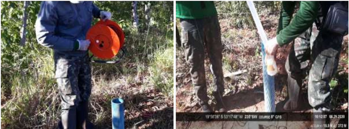
Figura 2 – Procedimentos de medição do nível d'água e de coleta de água dos poços de monitoramento. Fonte: Acari, 2020.
